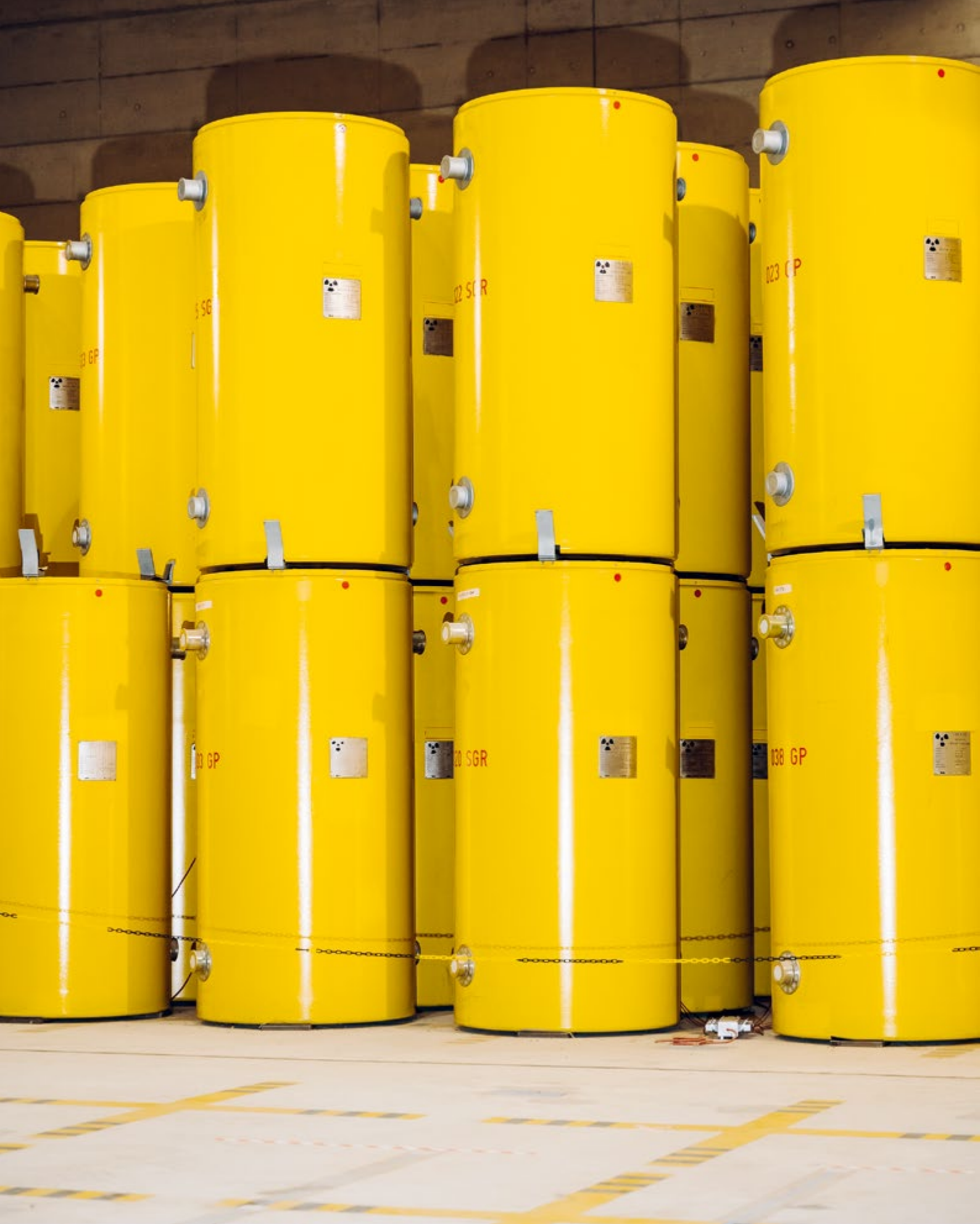
↑ CASTOR-THTR-Behälter, die mit bestrahlten Brennelementen beladen sind aus dem stillgelegten Thorium-Hochtemperatur-Reaktor (THTR) in Hamm-Uentrop im Transportbehälterlager Ahaus im Lagerbereich II. Die Lagerung ist zeitlich befristet, bis ein Endlager gefunden ist.
